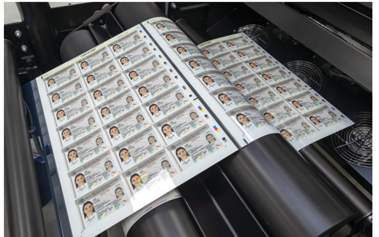
Las credenciales se imprimen con una tinta especial que genera un cambio de color de forma variable en función del ángulo de observación o de iluminación; este efecto se observa en el logotipo del INE ubicado en la parte superior derecha.
