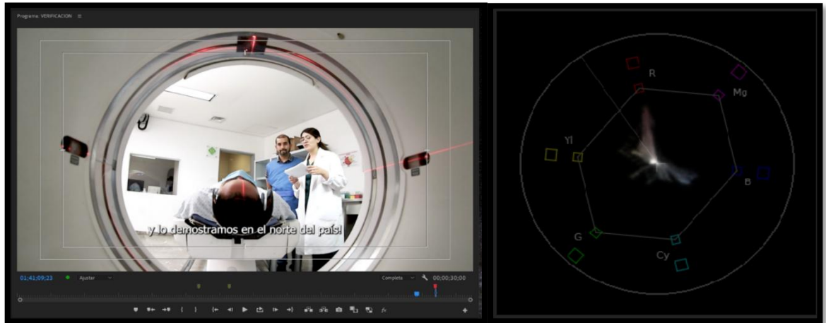
Ilustración 32. Imagen con problemas de Gamut y Vectorscopio que muestra la medición de saturación de color de la imagen
