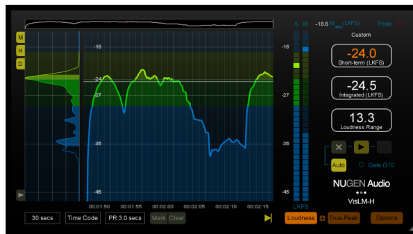
Ilustración 16. Interfaz del medidor VisLM
